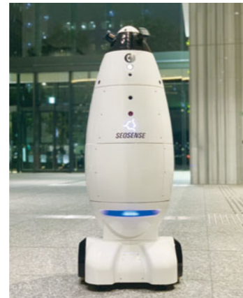
独自の3Dレーザーセンサーを活用した自律移動型警備ロボット「SQ-2」
