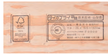
FSC®認証を取得した構造用合板
